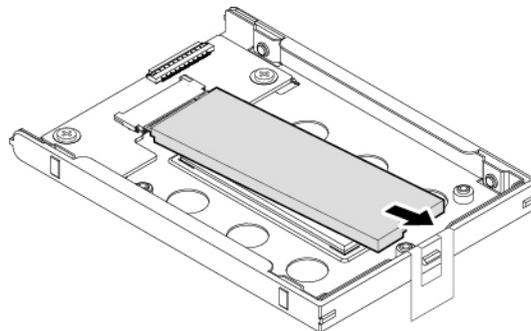
Gehen Sie wie folgt vor, um das neue M.2-Solid-State-Laufwerk zu installieren:
