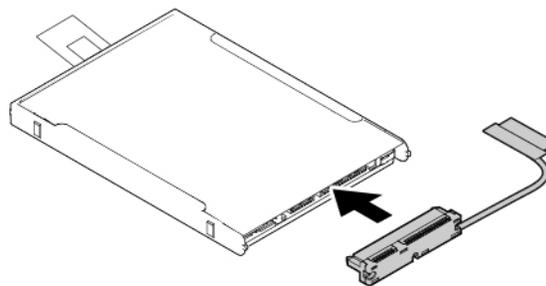
3. Setzen Sie das neue Speicherlaufwerk **1** ein und drehen Sie es nach unten **2**. Stellen Sie sicher, dass das neue Speicherlaufwerk fest sitzt und die Lasche den Lautsprecher nicht abdeckt.
