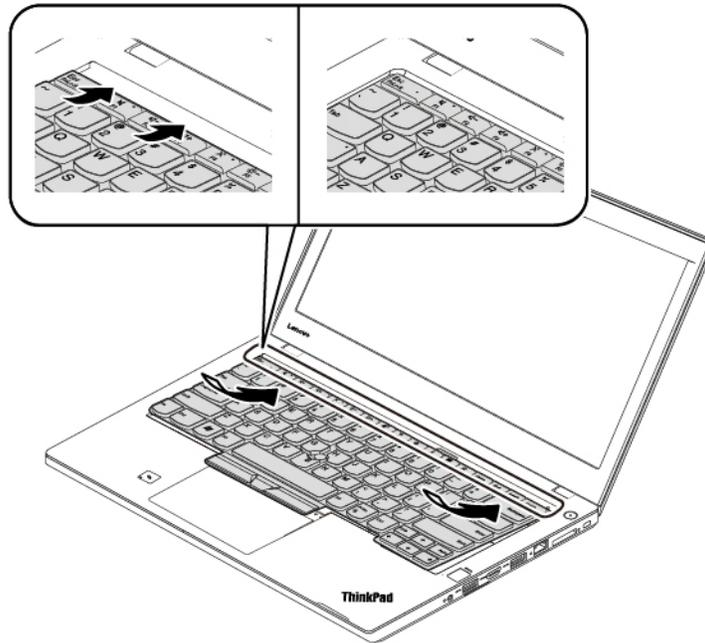
3. Schieben Sie die Tastatur in die durch die Pfeile angegebene Richtung. Vergewissern Sie sich, dass die Verriegelungen unter dem Tastaturrahmen gesichert sind.
