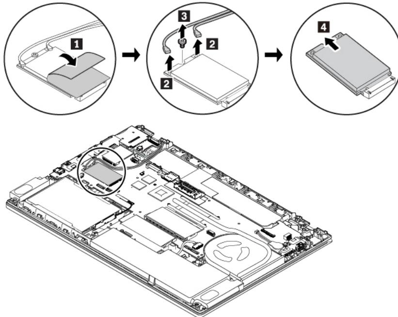
7. Installieren Sie eine neue Karte für drahtlose WAN-Verbindungen, indem Sie wie folgt vorgehen:
