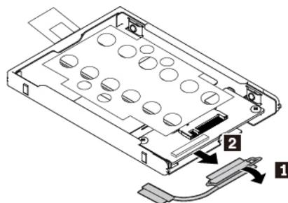
9. Entfernen Sie die zwei Schrauben, mit denen der M.2-Solid-State-Laufwerkadapter befestigt ist **1**, und entfernen Sie dann den Adapter **2**.
