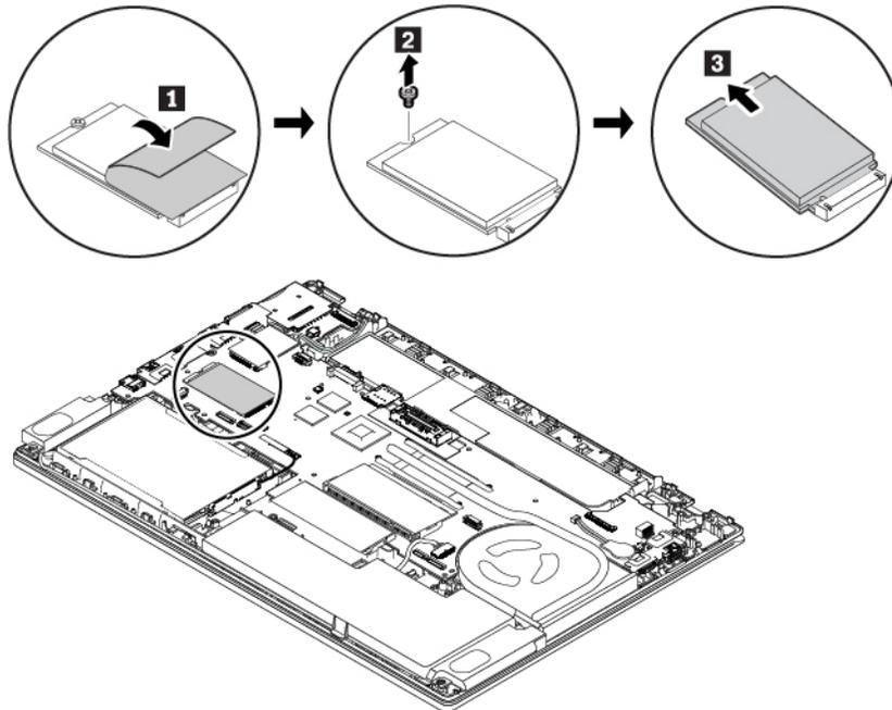
7. Gehen Sie wie folgt vor, um ein neues M.2-Solid-State-Laufwerk zu installieren:
