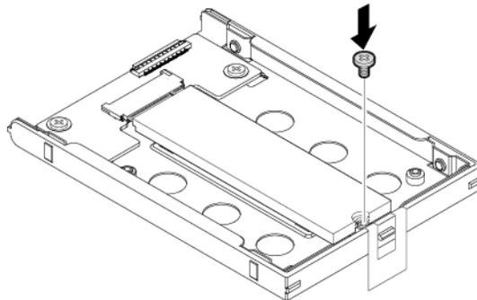
3. Bauen Sie den M.2 Solid-State-Laufwerkadapter ein, und ziehen Sie dann die zwei Schrauben an, um das M.2 Solid-State-Laufwerk zu befestigen.
