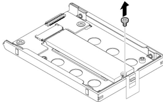
11. Ziehen Sie das M.2-Solid-State-Laufwerk vorsichtig aus dem Steckplatz.
