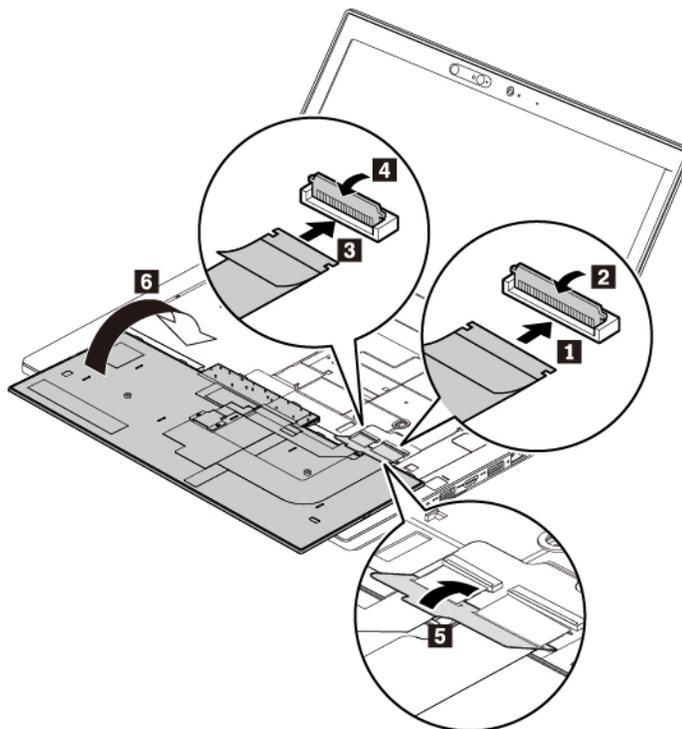
2. Setzen Sie die Tastatur wie abgebildet in die Tastaturblende ein. Stellen Sie sicher, dass sich der obere Rand der Tastatur (der zur Computeranzeige weisende Rand) unter dem Rahmen der Tastaturblende befindet.
