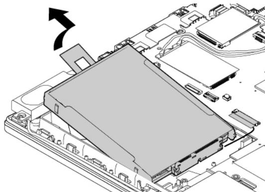
8. Ziehen Sie das Kabel vom 2,5-Zoll-Speicherlaufwerk ab.
