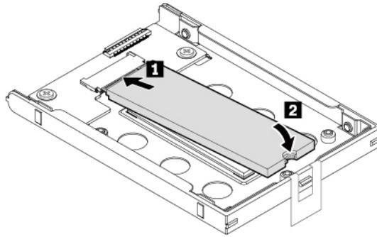
2. Bringen Sie die Schraube zur Befestigung des M.2-Solid-State-Laufwerks an.
