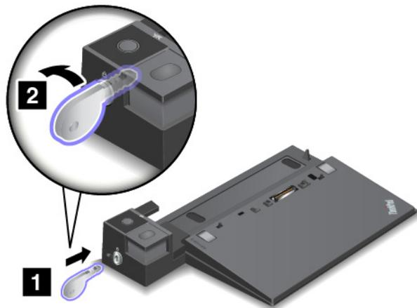
2. Setzen Sie den Computer in die Andockstation ein (siehe Abbildung), bis er hörbar einrastet **1**. Drehen Sie den Sperrschlüssel für das System in die gesperrte (vertikale) Position **2**.
