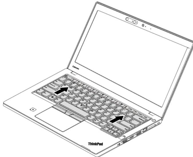
7. Schwenken Sie die Tastatur leicht nach oben, wie durch den Pfeil **1** dargestellt. Wenden Sie die Tastatur dann in die von Pfeil **2** angegebene Richtung.
