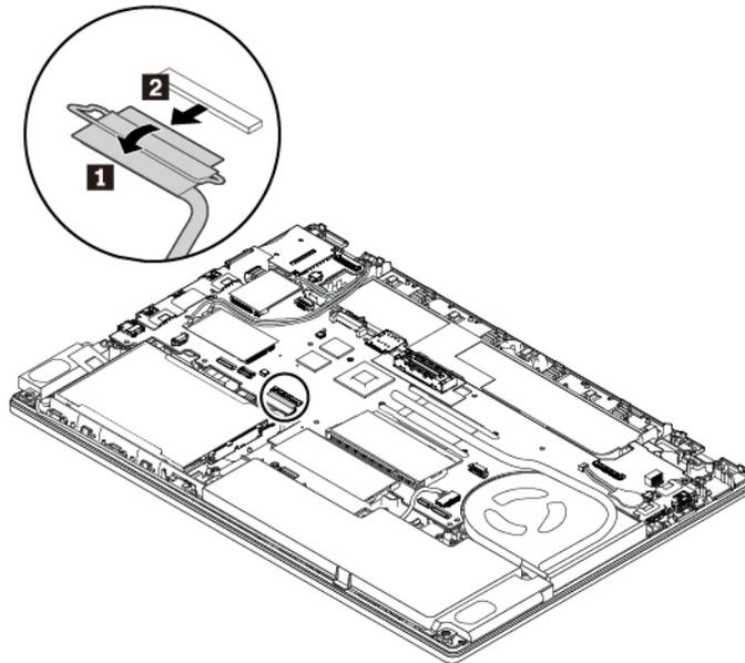
7. Ziehen Sie die Lasche, um den M.2-Solid-State-Laufwerkskonverter mit der Halterung zu entfernen.
