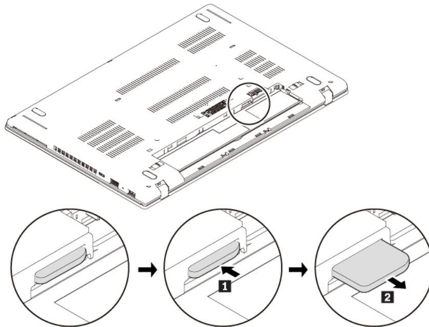
5. Merken Sie sich die Ausrichtung der neuen Micro-SIM-Karte und schieben Sie sie anschließend bis zum Einrasten in den Slot.
