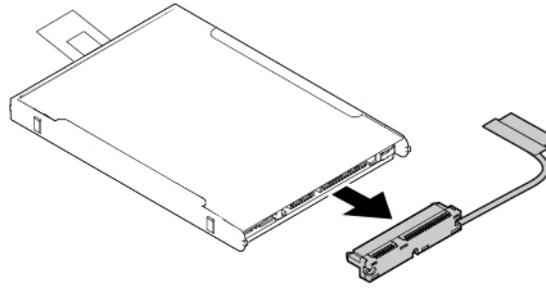
9. Lösen Sie anschließend das 2,5-Zoll-Speicherlaufwerk aus der Halterung.
