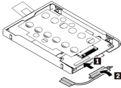
5. Setzen Sie den Konverter ein **1** und drehen Sie ihn dann nach unten **2**. Stellen Sie sicher, dass der Konverter fest sitzt und die Lasche den Lautsprecher nicht abdeckt.
