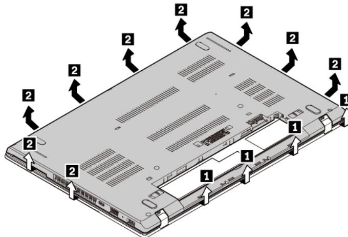
9. Befestigen Sie die Grundplattenabdeckung **1**. Vergewissern Sie sich, dass die Verriegelungen unter der Grundplattenabdeckung sicher sitzen. Ziehen Sie dann die Schrauben fest, um die Baugruppe für die untere Abdeckung zu fixieren **2**.
