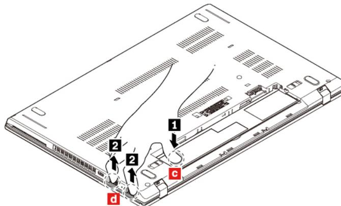
8. Entfernen Sie die Grundplattenabdeckung wie gezeigt in numerischer Reihenfolge.
