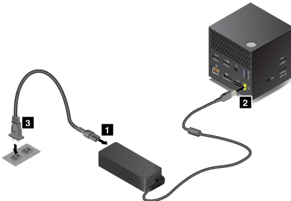
1. Schließen Sie das Netzkabel an das Netzteil an.
