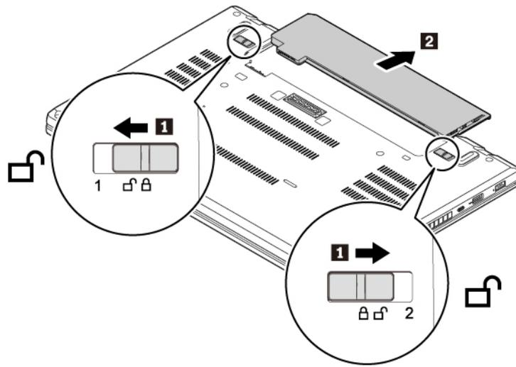
5. Setzen Sie einen neuen Akku so ein, dass er hörbar einrastet. Stellen Sie sicher, dass sich die Verriegelungen in der gesperrten Position befinden.
