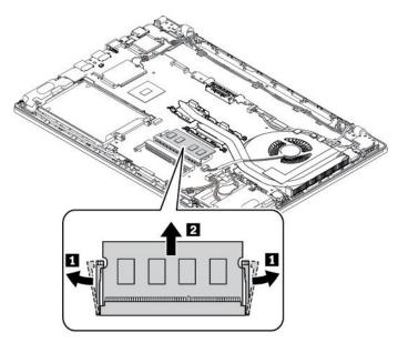
6. Setzen Sie das neue Speichermodul in einem Winkel von etwa 20 Grad in den Speichersteckplatz ein 11. Klappen Sie das Speichermodul nach unten, bis es hörbar einrastet 2. Stellen Sie sicher, dass das Speichermodul fest im Speichersteckplatz installiert ist und nur schwer bewegt werden kann.
