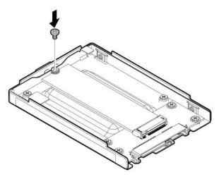
11. Bringen Sie die Schutzabdeckung an 1, und entfernen Sie dann die Schrauben, um die Abdeckung zu sichern 2.
