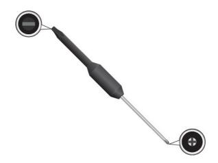
6. Um die Schraubenköpfe unter dem Tastaturrahmen freizulegen, schieben Sie den Tastaturrahmen mit dem flachen Ende des Tastatur-Multifunktionswerkzeugs um 2,5 mm nach vorne.
