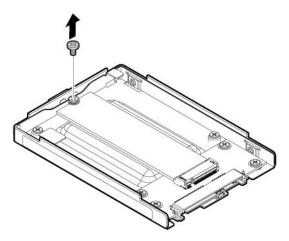
8. Nehmen Sie das M.2-Solid-State-Laufwerk aus dem Steckplatz heraus.
