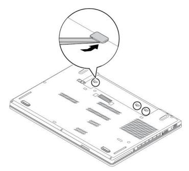
5. Nehmen Sie das Tastatur-Multifunktionswerkzeug aus der Versandverpackung der neuen Tastatur. Die folgende Abbildung zeigt ein Tastatur-Multifunktionswerkzeug.
