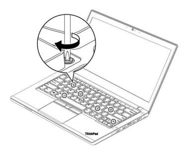
5. Schieben Sie den Tastaturrahmen mithilfe des flachen Endes des Tastatur-Multifunktionswerkzeugs um 2,5 mm nach hinten. Stellen Sie sicher, dass sich die Verriegelungen des Tastaturrahmens unter der Tastaturblende befinden.
