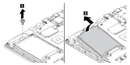
6. Entfernen Sie die Schrauben, die die Schutzabdeckung sichern 1, und entfernen Sie dann die Abdeckung 2.
