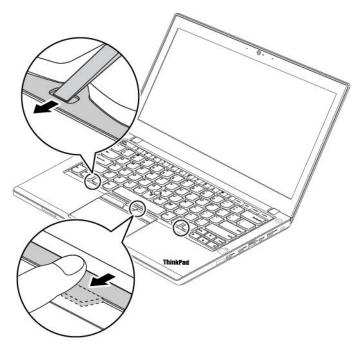
6. Führen Sie das flache Ende des Tastatur-Multifunktionswerkzeugs wie in der Abbildung gezeigt an den Seiten der Tastatur ein und schieben Sie den Tastaturrahmen nach hinten. Stellen Sie sicher, dass zwischen dem Tastaturrahmen und der Tastaturblende kein Spalt ist.
