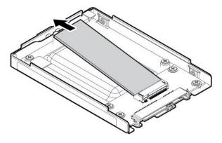
9. Richten Sie die Kante mit den Kontakten des neuen M.2-Solid-State-Laufwerks an der Aussparung des zugehörigen Steckplatzes aus 1. Setzen Sie dann das neue Laufwerk vorsichtig in einem Winkel von ca. 20 Grad in den Steckplatz ein. Drehen Sie das neue Laufwerk nach unten 2.
