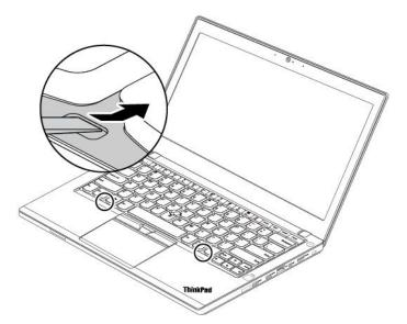
7. Lösen Sie die Schrauben mit der Kreuzschlitzseite des Tastatur-Multifunktionswerkzeuges.
