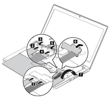
2. Setzen Sie die Tastatur wie abgebildet in die Tastaturblende ein. Stellen Sie sicher, dass sich die vordere Kante der Tastatur (die zum Bildschirm weisende Kante) unter dem Rahmen der Tastaturblende befindet.
