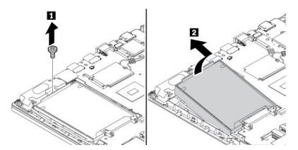
6. Lösen Sie das Festplattenlaufwerk aus der Halterung und bringen Sie die Halterung dann am neuen Festplattenlaufwerk an.
