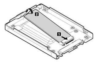
10. Bringen Sie die Schraube zur Befestigung des M.2-Solid-State-Laufwerks an.
