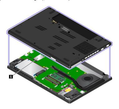
Anmerkung: Stellen Sie für das durch den Benutzer installierbare Modul sicher, dass Sie nur ein von Lenovo autorisiertes drahtloses Modul für den Computer verwenden. Andernfalls werden beim Einschalten des Computers eine Fehlernachricht angezeigt und akustische Signaltöne ausgegeben.
