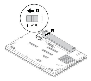
4. Schieben Sie die andere Akkuverrieglung 1 in die entriegelte Position und entnehmen Sie den Akku 2 aus der unteren Abdeckung auf der rechten Seite.
