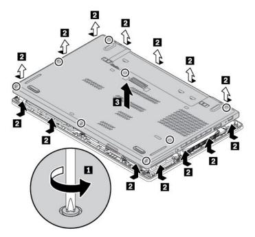
7. Bringen Sie die neue Baugruppe für die untere Abdeckung 1 wieder an und ziehen Sie dann die Schrauben an 2.
