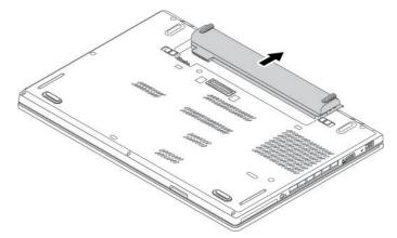
6. Setzen Sie einen neuen Akku so ein, dass er hörbar einrastet. Stellen Sie sicher, dass sich die Akkuverrieglungen in der gesperrten Position befinden.
