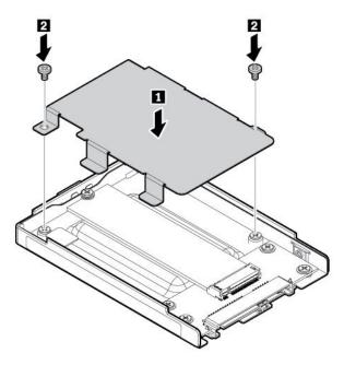
12. Setzen Sie den neuen Adapter für das M.2-Solid-State-Laufwerk 1 ein und drehen Sie ihn nach unten 2. Vergewissern Sie sich, dass der Adapter fest im Steckplatz sitzt. Bringen Sie dann die Schraube an 3, um den Adapter zu fixieren.
