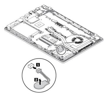
6. Setzen Sie die neue Knopfzellenbatterie 1 ein und schließen Sie dann den Stecker 2 an.
