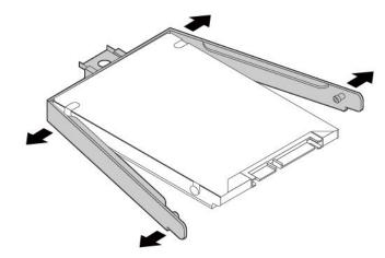
7. Setzen Sie das neue Festplattenlaufwerk ein 1 und kippen Sie es nach unten 2. Stellen Sie sicher, dass das neue Festplattenlaufwerk eingerastet ist. Bringen Sie danach wieder die Schraube 3 an, um das neue Festplattenlaufwerk zu sichern.
