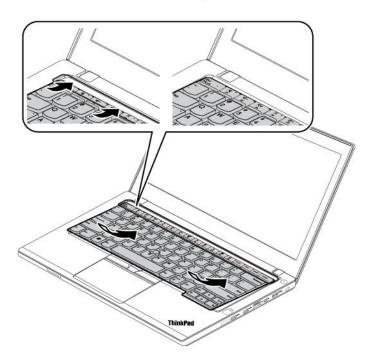
3. Stellen Sie sicher, dass die Schraubenköpfe vollständig freigelegt sind. Legen Sie die Schraubenköpfe anderenfalls frei, indem Sie den Tastaturrahmen mit dem flachen Ende des Tastatur-Multifunktionswerkzeugs nach vorne schieben.
